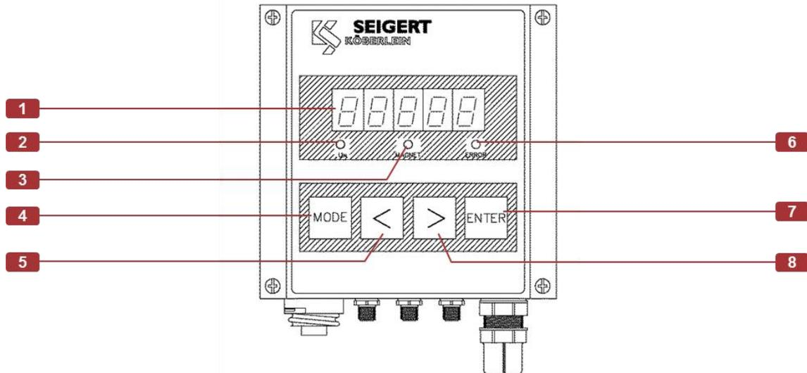
Abbildung 6: RMA – Bedientasten
